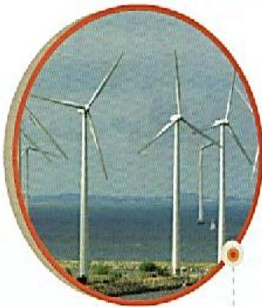
Los aerogeneradores, que se utilizan para generar electricidad a partir del movimiento del aire, son colocados en áreas expuestas a vientos frecuentes.
